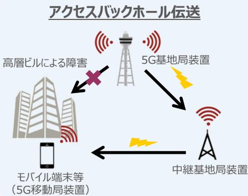
直進性の高い「ミリ波」を中継アンテナを経由し、障害の多い場所まで届けることに成功。経路による反応速度や通信速度の低下をわずかに留め、5Gのカバレッジを拡大
