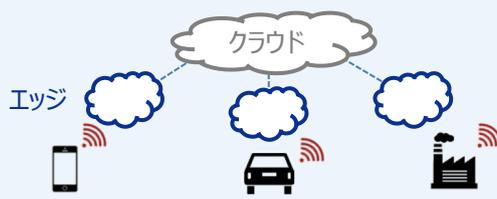
一定エリア内の通信処理の効率化を図る技術。基地局のそばにサーバを置くことで、通信の遅延を低減
